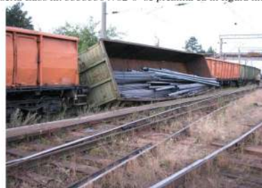
Fig. nr.2: Vagonul seria Eaos nr. 33535304702-0 deraiat
